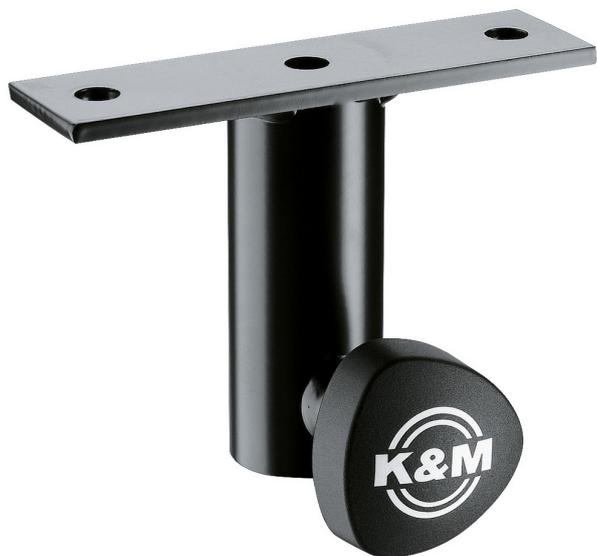
Aufsteckbar auf Boxenstative mit Rohr- $\varnothing$  35 mm. Passend für Boxen und Flugrahmen. Mit zwei Befestigungslöchern  $\varnothing$  11 mm im Abstand von 115 mm und Arretierungsschraube für Stativbefestigung. Inkl. je 2 Stück Befestigungsschrauben M10 x 40 mm, Scheiben und Muttern.
