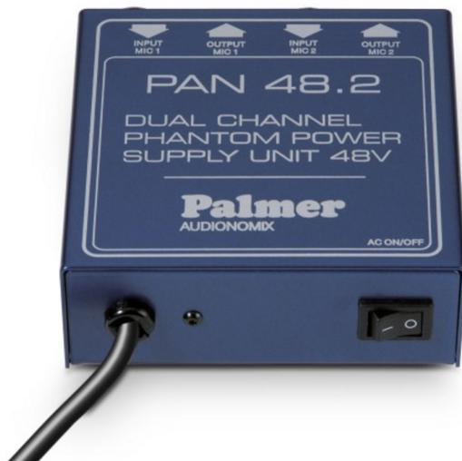
Palmer Pan 48 ist ein Gerät zur externen Spannungsversorgung phantomgespeister Geräte. Aufgrund der hohen Stromleistung von 20mA total ist die Anwendung nicht nur auf Kondensatormikrofone beschränkt, PAN 48 eignet sich auch hervorragend, um z.B. phantomgespeiste aktive DI-Boxen zu versorgen. Die Box ist zweikanalig ausgelegt. Die Stromversorgung erfolgt über ein internes Netzteil.
