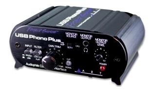
Der USB Phono Plus ist die perfekte Lösung um Musik von Ihrem Plattenspeieler auf einen Computer zu übertragen. er ist auch als hochweriges Audio - Interface zu verwenden. Die verwendeten RIAA Phono Pre-Amp Schaltungen mit Low-Cut Filtern, die "rumpeln" und Geräusche filtern, garantieren superbe Audio-Übertragung.
