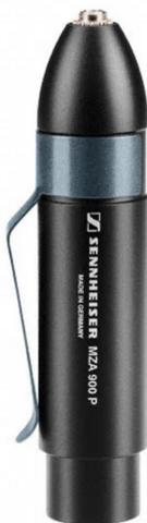
Der Phantomspeise-Adapter MZA 900 P dient zum Betrieb von dauerpolarisierten Kondensator-Mikrofonen an Mikrofoneingängen mit 10 - 52 V Phantomspeisung (P12 - P48). Das angeschlossene Mikrofon wird aus dem Adapter gespeist.
