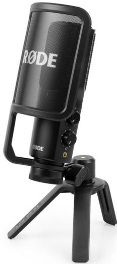
USB-Kondensatormikrofon Das NT-USB+ -- ist ein professionelles USB-Kondensatormikrofon, das sich ideal für die Aufnahme von Vocals, akustischen Instrumenten, Podcasts oder auch für Online-Meetings eignet. Das NT-USB+ hat einen integrierten DSP, um das Aufnahmesignal bereits im Mikrofon mit Hochpassfilter, Noise Gate, Kompressor und APHEX® bearbeiten zu können. Die Bedienung des DSPs erfolgt über RODEs kostenlose Streaming-/Recording-Software RODE Connect.
