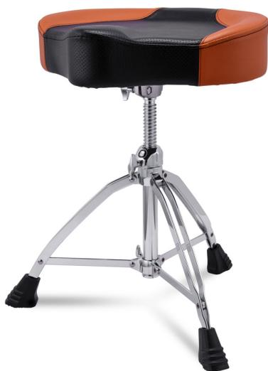
Modell MXT855BR Höheneinstellung 483 mm - 635 mm Sitz Sattelsitz, atmungsaktiver Sitz mit braunem Kunstleder Sitzgröße 432 mm x 102 mm Beine 3 Stück, doppelstrebig Besonderheiten Ultra-Secure Clamp Mount, Höhenverstellung durch Stahlspindel mit Gewinde und Spindelarretierung, Extra große und rutschsichere Füße
