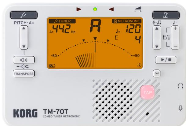
Das KORG TM-70T ist das ultimative Stimm- und Rhythmus-Trainingsgerät für Blas- und Streichinstrumente. Mit einer neuen Transponierfunktion, verbessertem Display und optimierter Klangqualität des Metronoms setzt das kompakte Combo-Gerät neue Maßstäbe in Präzision und Benutzerfreundlichkeit. Hergestellt in Japan unterstreicht es KORGs langjährigen Fokus auf Qualität und Innovation.
