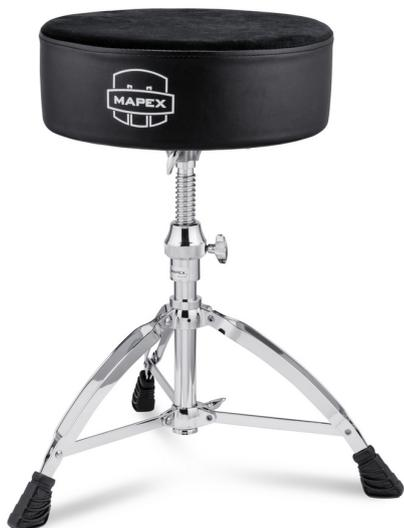
Modell MXT680 Höheneinstellung 410 - 620 mm, Stahlspindel mit Gewinde und Spindelarretierung Sitz Rundsitz, weicher Stoffbezug Sitzhöhe 102 mm Sitzgröße Durchmesser 356 mm Beine doppelstrebig
