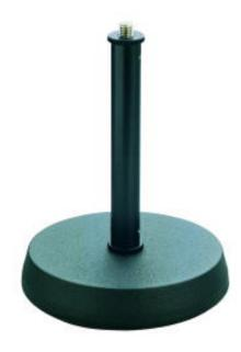
König & Meyer Tischstativ 232 für Mikrofon Gussrundsockel mit spezieller Gummieinlage zur Schalldämpfung. Übertragungsgeräusche an das Mikrofon werden verhindert. Aufschraubbares Rohr mit 3/8 " Gewindeanschluss. Gewicht: 1,0 kg, H: 175 mm, Sockel-Ø 130
