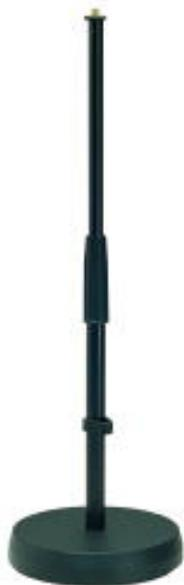
Gußrundsockel schwarz kunststoffbeschichtet mit spezieller Gummieinlage zur Schalldämpfung. Aufschraubbare, höhenverstellbare Rohrkombination. Sockel-Ø 180 mm. Gewicht: 2,5 kg, H: 355/580 mm.
